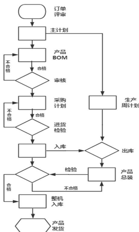
与同行业企业大都采用流水线的传统生产方式不同，公司采用“流水线作业+作业岛”相结合方式，实现小批量、多品种的需求。如单元部件采用流水线方式，柜体装配采用作业岛作业方式，细化装配单位，采用先部件再整机、标准部件小批量备货、各工序并行或串行等工作模式，提高生产制造过程灵活性和应变能力、缩短产品生产周期，实现柔性生产，从而大幅度提高了公司对客户多样化需求的反应能力。
